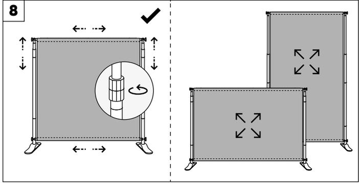
**i** La largeur et la hauteur maximum est de 3 m ; ne pas développer la structure au-delà. Le repérage numéroté facilite l'assemblage des sections entre elles.
